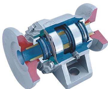
Cojinetes/Chumaceras con dos rodamientos cónicos lubricados en baño de aceite - DUROMARK® (DM), que utilizan retenes Duo-Cone, sin pérdidas y sin contaminación por materiales abrasivos. El cambio de aceite a cada mil horas ahorra lubricantes y mano de obra, evitando las paradas diarias.
