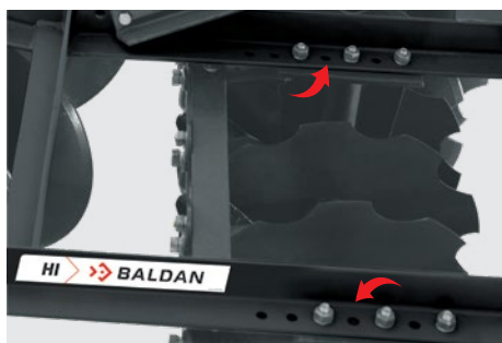
Regulagens para aumentar ou diminuir o ângulo de corte dos discos. Adjustments to increase or decrease the cutting angle of the discs. Ajustes para aumentar o disminuir el ángulo de corte de los discos.
