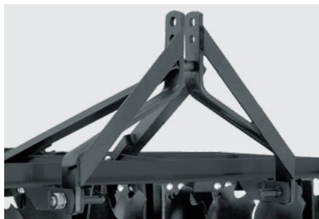
Engate hidráulico categoria I e II. Cat I - II. 3 point hitch. Enganche hidráulico categoria I y II.
